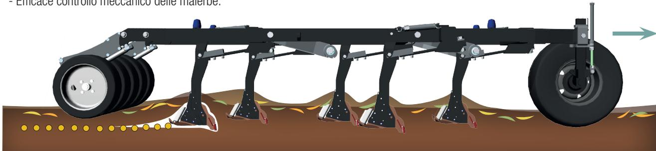
L'elemento di semina ad alette UST (brevettato) permette di ottenere il solco di semina sollevando uno strato di terreno che si deposita sopra il seme dopo il passaggio dell'elemento stesso. Questa tecnologia garantisce di deporre il seme nel terreno senza farlo entrare in contatto con i residui colturali presenti. Inoltre le alette garantiscono un'efficace azione di diserbo meccanico.
