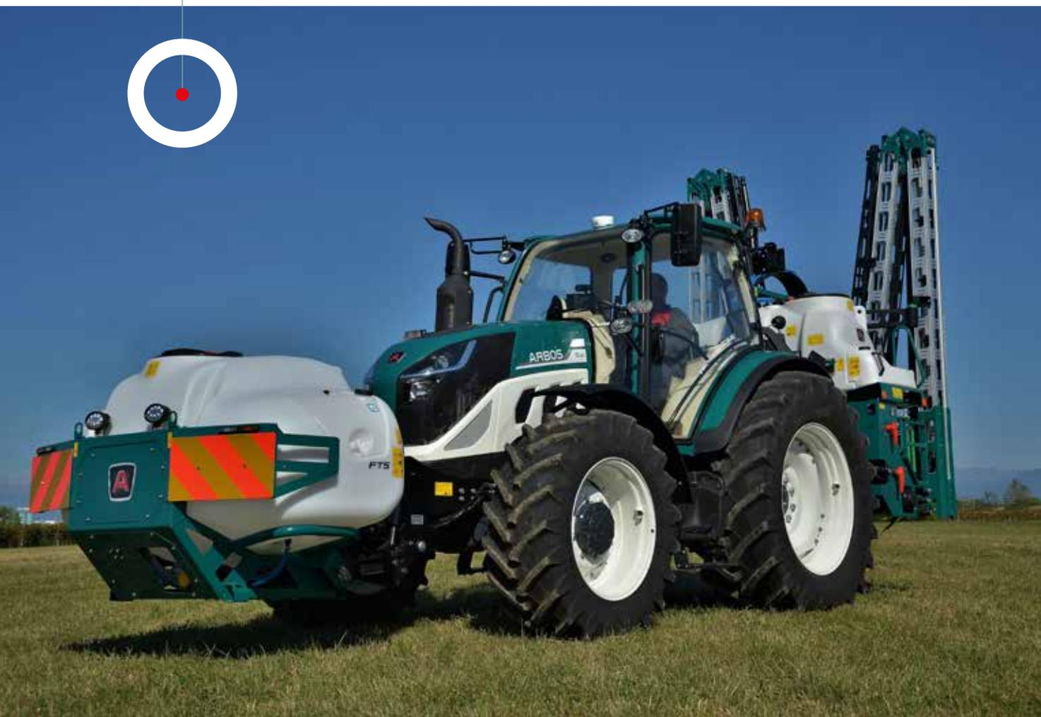
El depósito frontal FTS es la ampliación de la gama de pulverizadores MBS para aumentar la autonomía de la máquina y equilibrar los pesos.
