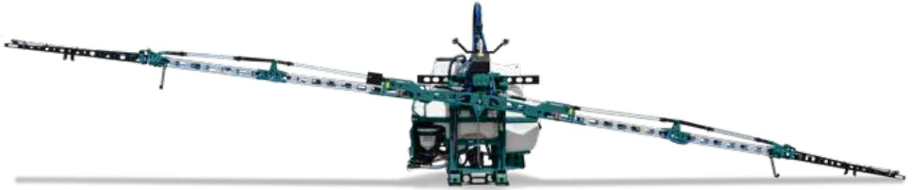
Barra: 12 m, 5 secciones, número de boquillas 6 - 4 - 4 - 4 - 6
