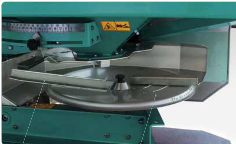
Sistema de pesado con calibración automática y continua con 4 celdas de carga. Gracias al filtrado automático, calcula las diferentes características del abono con la máxima precisión y fiabilidad incluso durante el movimiento.
